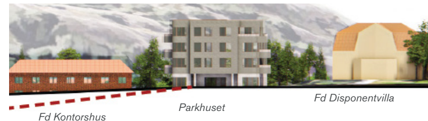
Elevation som visar hur det före detta kontorshuset utmed den interna industrigatan kommer att förhålla sig till den föreslagna väghöjningen och ny bebyggelse. Den röda streckade linjen är nivån för den nuvarande gatan.
